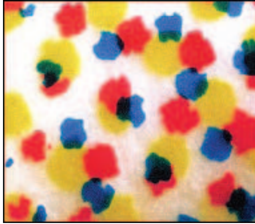
Figura 22-1. Aspecto de los puntos de trama en la impresión serigráfica. Ampliación.
