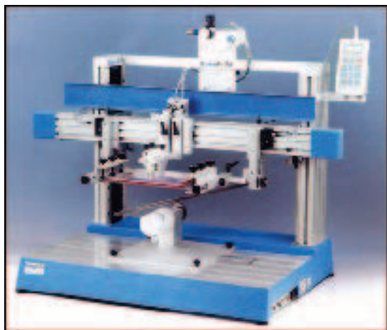
Figura 22-4. Máquina serigráfica para la impresión de objetos cilíndricos como botellas o envases, que se sujetan en la parte inferior, mientras la pantalla gira para adaptarse a la forma.
