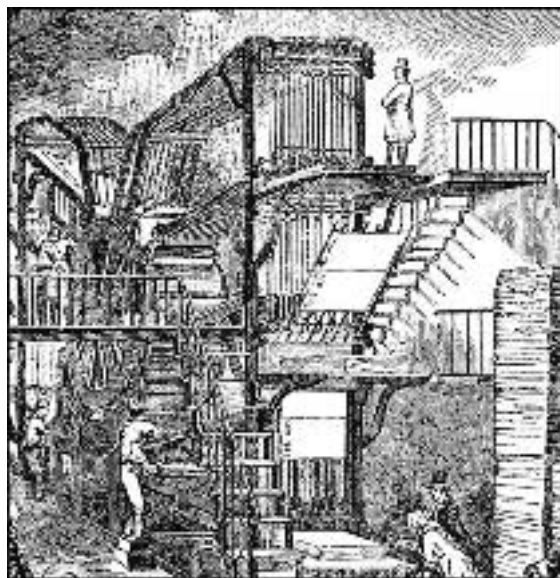
Figuras 16-3 y 16-4. En la otra página, sistema de impresión del Times de Londres en la segunda década del siglo XIX. Conseguía algo más de mil pliegos por hora. Junto a estas líneas, una máquina de Richard Hoe imprimiendo el periódico americano The Sun.
