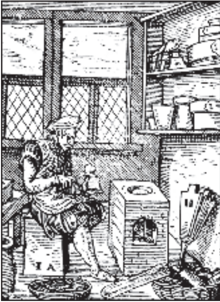
Figura 4-6. Grabado xilográfico en el que se representa un fabricante de tipos móviles en el momento de verter el metal fundido en el molde. Apréciese la similitud con la Figura 4-2.
